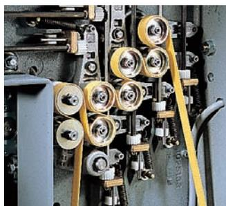
Rulli di piega a segmenti alternati ferro-gomma di lunghissima durata e di elevata precisione.
